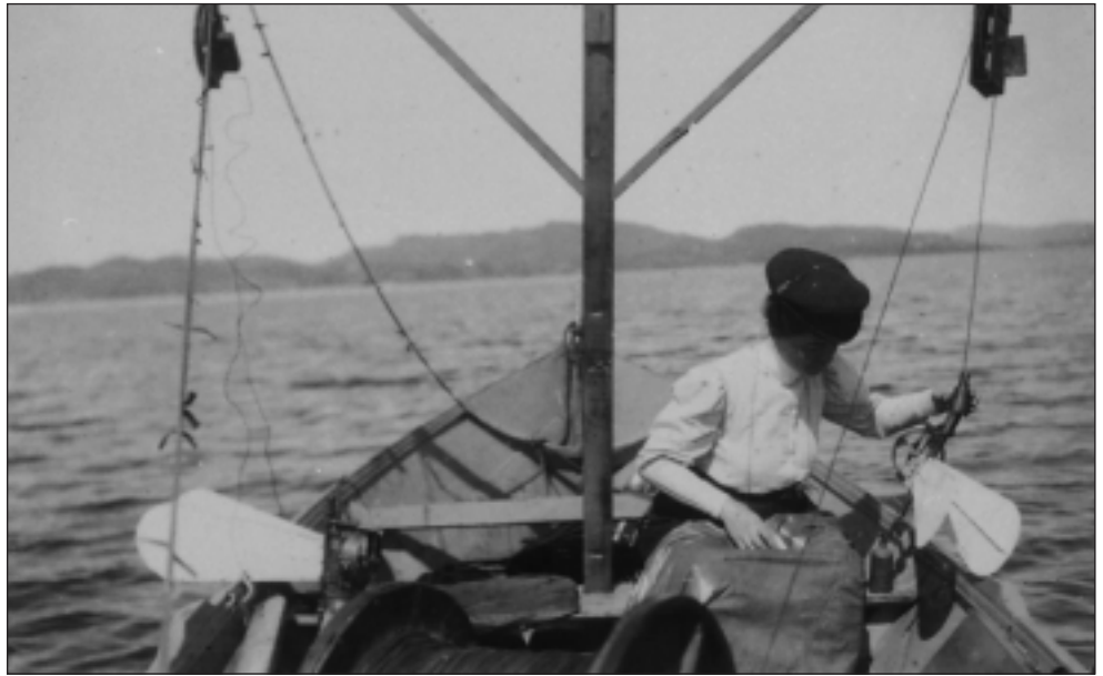
De internasjonale havforskningskursene i Bergen (1902-1913) bidro til å spre kunnskap til forskere og teknikere i ICES-landene. Fotoet viser tyske Margarete Schröer som senker en Ek-mans strømmåler i Bergensfjorden i 1908. Det velstående ekteparet Schröer hørte til de ytterst få som har dyrket havforskning av lyst og uten lønn (foto: H. Brachmann/Archiv Deutsche Schifffahrtsmuseum, Bremerhaven).
